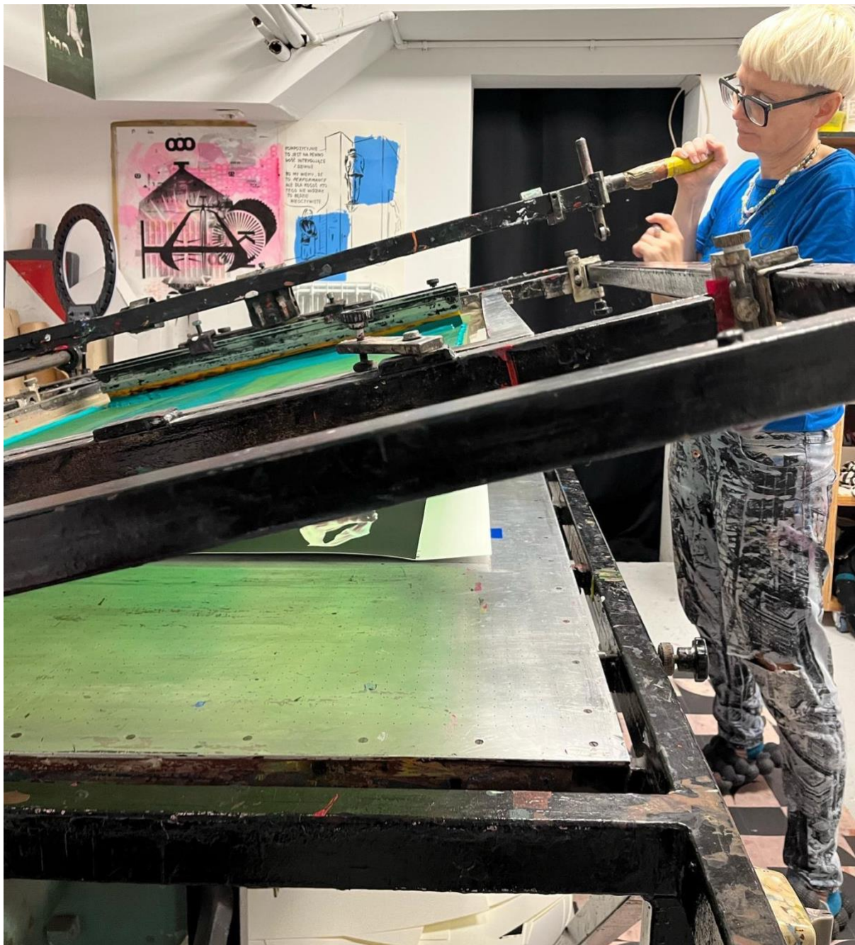
Ilustracja 12. Druk na stole z prowadzeniem rakla Fot. I. Kosik
